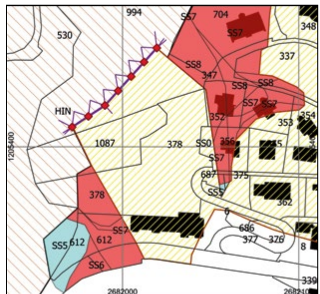
Grafik 2: Gefahrenkarten von Sturzprozessen vor (links) und nach (rechts) der Massnahme; erhebliche Gefährdung (rot); mittlere Gefährdung (hellblau); Restgefährdung (gelb schraffiert); Schutznetz (rot und violett).
