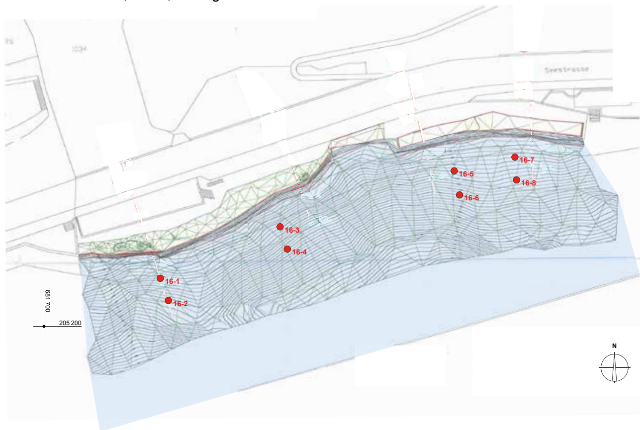
Abbildung 1 Situation mit Seegrundvermessung und Lage der Rammsondagen
